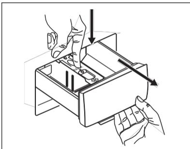
2. Для облегчения очистки снимите верхнюю часть отсека для присадок и промойте ее под теплой проточной водой, удаляя скопившиеся остатки моющего средства. После очистки установите деталь на место.
