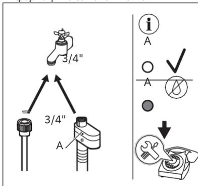
5. Подключите другой конец гибкого соединения на входе воды HIGH к крану холодной воды с резьбой 3/4".
