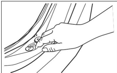
При необходимости очистите его с помощью кремообразного с аммиаком, не царапая уплотнительную поверхность.
