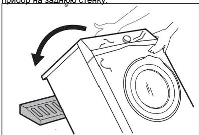
5. Снимите защитный элемент из полистирола с нижней стороны прибора.
