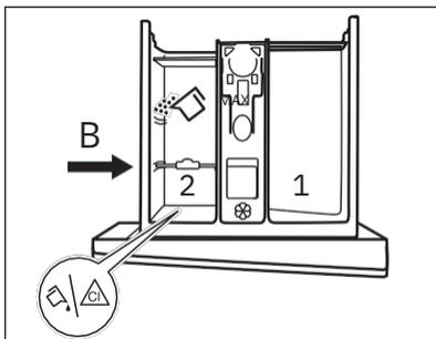
Положение **B** сепаратора моющих средств предназначено для порошка в заднем отсеке и жидкого моющего средства/добавки или отбеливателя в переднем отсеке.
