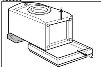
6. Установите прибор в вертикальное положение. Отсоедините кабель питания и шланг для слива воды от шланга держатель.
