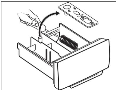
3. Удалите все остатки моющего средства с верхней и нижней части углубления. Очистите углубление с помощью небольшой щетки.
