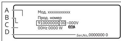
На табличке с техническими характеристиками указаны название модели (A), номер изделия (B), электрические характеристики (C) и серийный номер (D).
