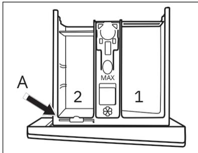
2. Чтобы использовать жидкое моющее средство/добавку или отбеливатель: Выньте сепаратор для моющих средств из положения **A** и вставьте в положение **B**.
